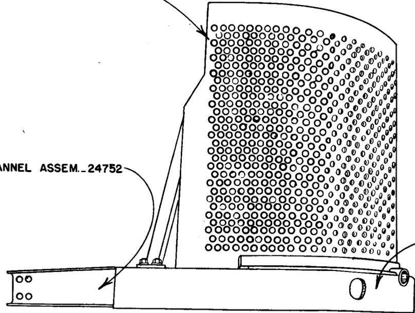
RADIATOR GUARD & BUMPER FOR D6 (RD6) & 40 DIESEL TRACTORS
