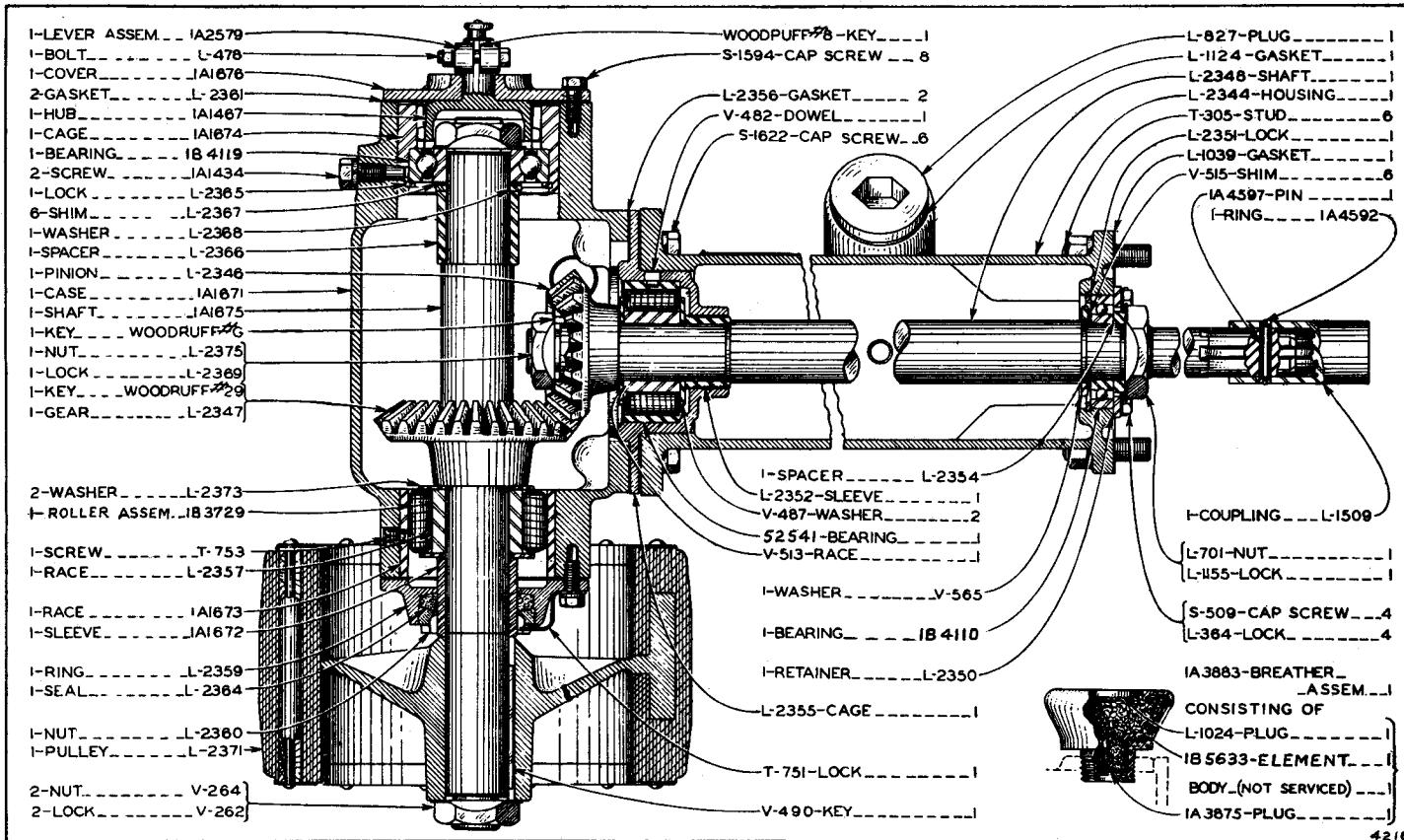
1A1689 BELT PULLEY DRIVE GROUP—WITH PULLEY
