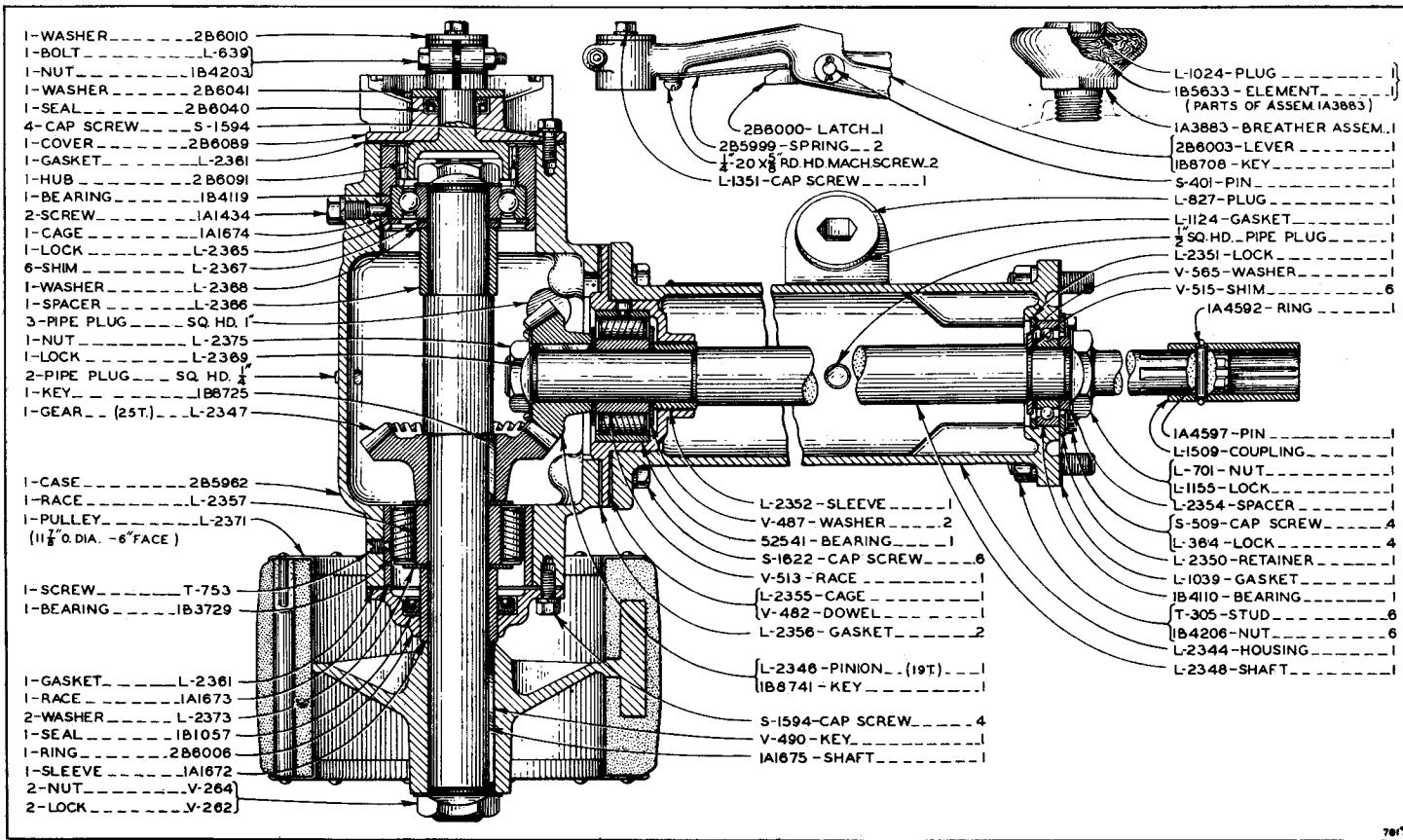
2B6022 BELT PULLEY DRIVE GROUP—WITH PULLEY
