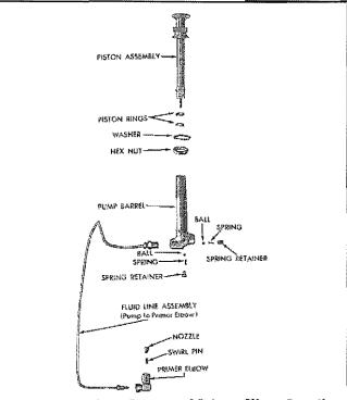
Fig. 26 — Primer Pump and Primer Elbow Details \_
